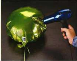
الشكل 9 يزداد حجم الهواء الموجود داخل البالون بارتفاع درجة الحرارة.
