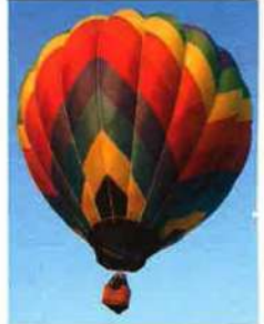
الشكل 11 يتحكم المسوقون عن المناطق بمناطيدهم من خلال استخدام التمدد الحراري والانكماش الحراري.
