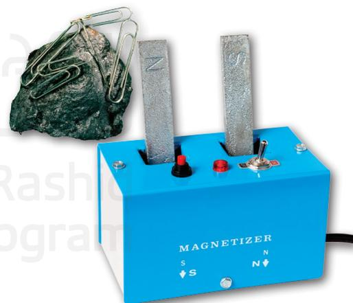
الشكل 19 إنّ حجر المغناطيس عبارة عن مغناطيس دائم طبيعي. يمكن تصنيع مغناطيس دائم في المختبر بواسطة ميفنطاط كهربائي.
