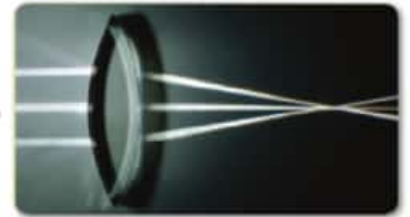
الشكل 9 تكسر العدسة المحدبة الضوء إلى الداخل مع المحور البصري. أما شعاع الضوء الذي يمر عبر مركز العدسة مباشرة فلا يتكسر. حواف النقطية البؤرية للعدسة.
