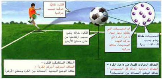
الشكل 2: تحدد طاقة الوضع الخاصة بكرة القدم على المسافة بينها وبين الأرض، وتحدد طاقة وضع جسيمات المادة على المسافة التي تفصل بينها.
