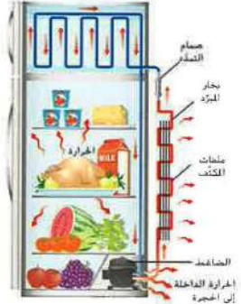
الشكل 15 يَبلُغ السائل المبرّد الطاقة الحرارية من داخل الثلاجة إلى خارجها.
